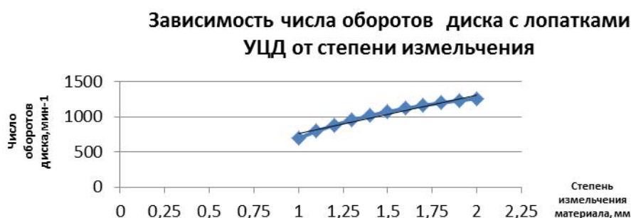
Рисунок 2- Зависимость числа оборотов диска с лопатками УЦД от степени измельчения
