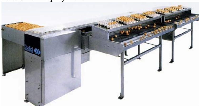
Рисунок 2 – Яйцесортировочная линия фирмы Inter Compacta
