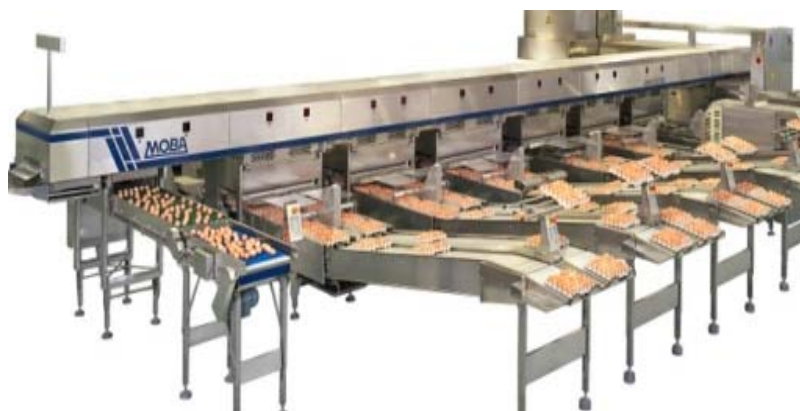
Рисунок 1 – Яйцесортировочная линия фирмы Moba
